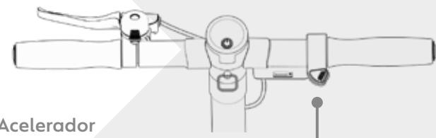
Puede reducir la velocidad del patinete apretando la maneta de freno del lado izquierdo del manillar. El frenado activará tanto el freno eléctrico trasero como el freno de tambor delantero.
