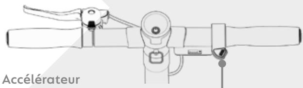
Vous pouvez faire ralentir votre trottinette électrique en tirant le levier de frein situé sur la partie gauche du guidon. Le freinage actionnera à la fois le frein arrière électrique et le frein à tambour avant.
