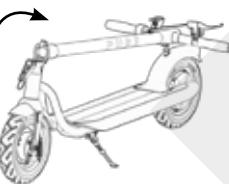
3 Dévissez le guidon dans le sens inverse des aiguilles d'une montre jusqu'à ce que le collier en U soit libéré des trous. Ne l'enlevez pas complètement.
